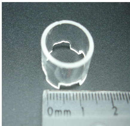
Figura 1. La celda de Van Tiegham es un cilindro con una de las superficies dentadas.
