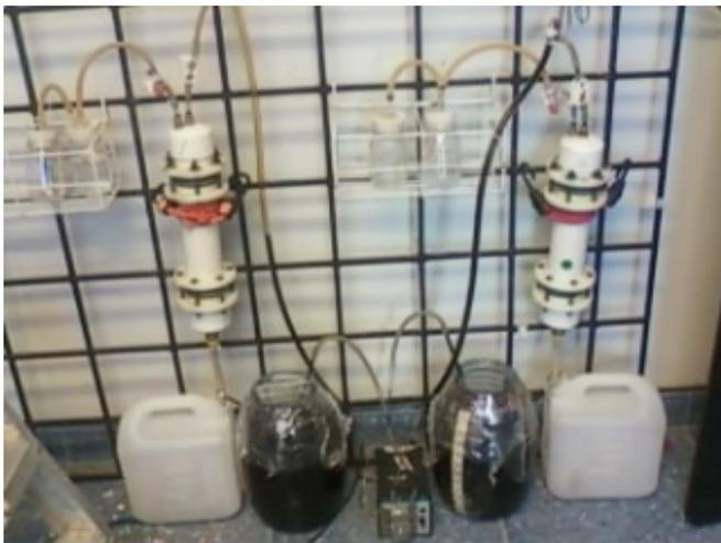
**Figura 1.** Reactores digestores anaerobios conectados a sistema de recolección de lixiviados y medición de biogás por desplazamiento.
